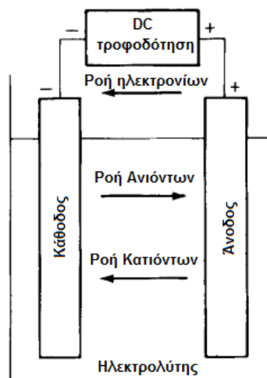
Η διαδικασία φόρτισης ενός επαναφορτιζόμενου στοιχείου
