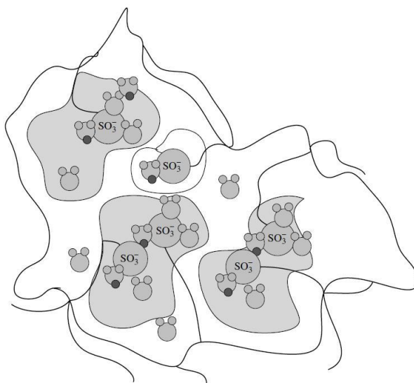
Σχήμα 3.2 Εικονική αναπαράσταση δομής μεμβράνης τύπου nafionτης Dupont
