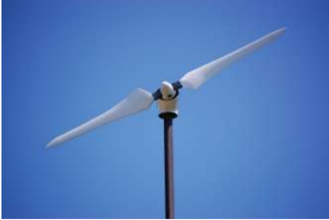
Εικόνα 4.2 Αιωρούμενη πλήμνη σε δίπτερη ανεμογεννήτρια 5
