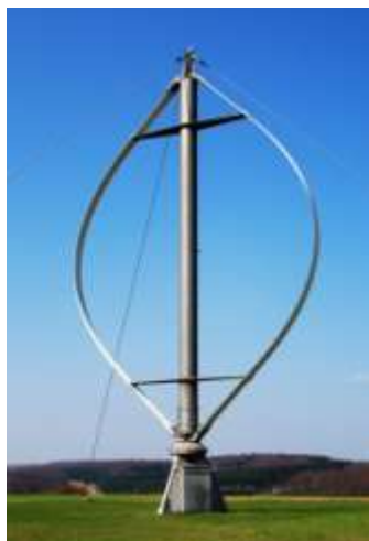
Εικόνα 4.5 Ανεμογεννήτρια κατακόρυφου άξονα τύπου Darrieus 11
