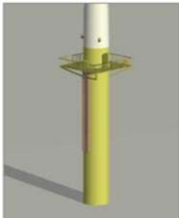
Εικόνα 4.7 Δομή υποστήριξης τύπου Μονού πυλώνα 13
