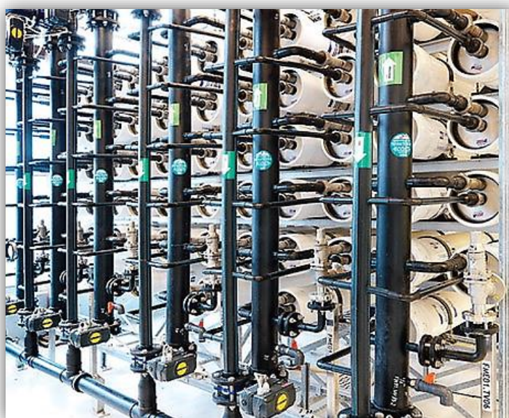
Σχήμα 5.9: Στοιβες μεμβρανών. Ανάκτηση από [99] .
