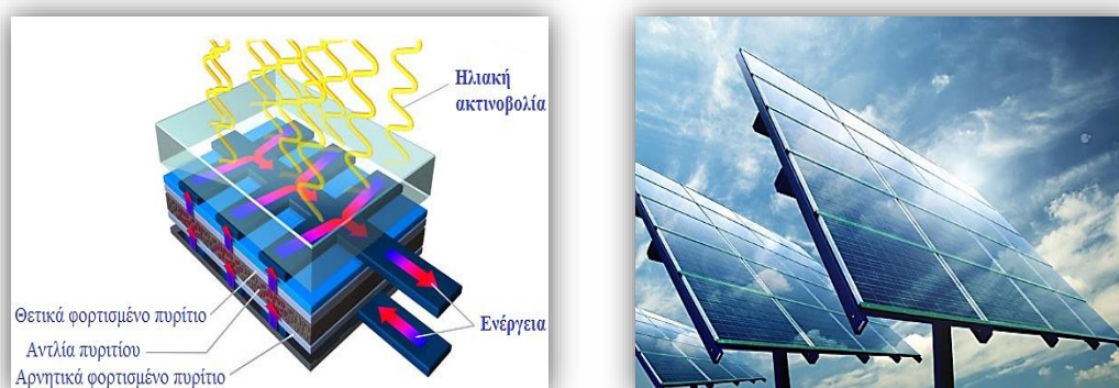
Σχήμα: 2.1: Αριστερά σχηματική απεικόνιση φωτοβολταϊκής κυψέλης, δεξιά μια ενδεικτική τοποθέτηση των φωτοβολταϊκών. Ανάκτηση από [18,19] .
