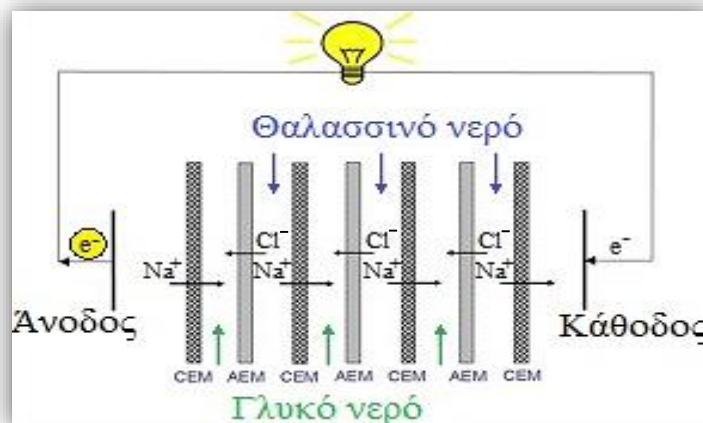
Σχήμα 2.6: Σχηματική απεικόνιση Αντίστροφης Ηλεκτροδιάλυσης (RED). Πηγή [48] .
