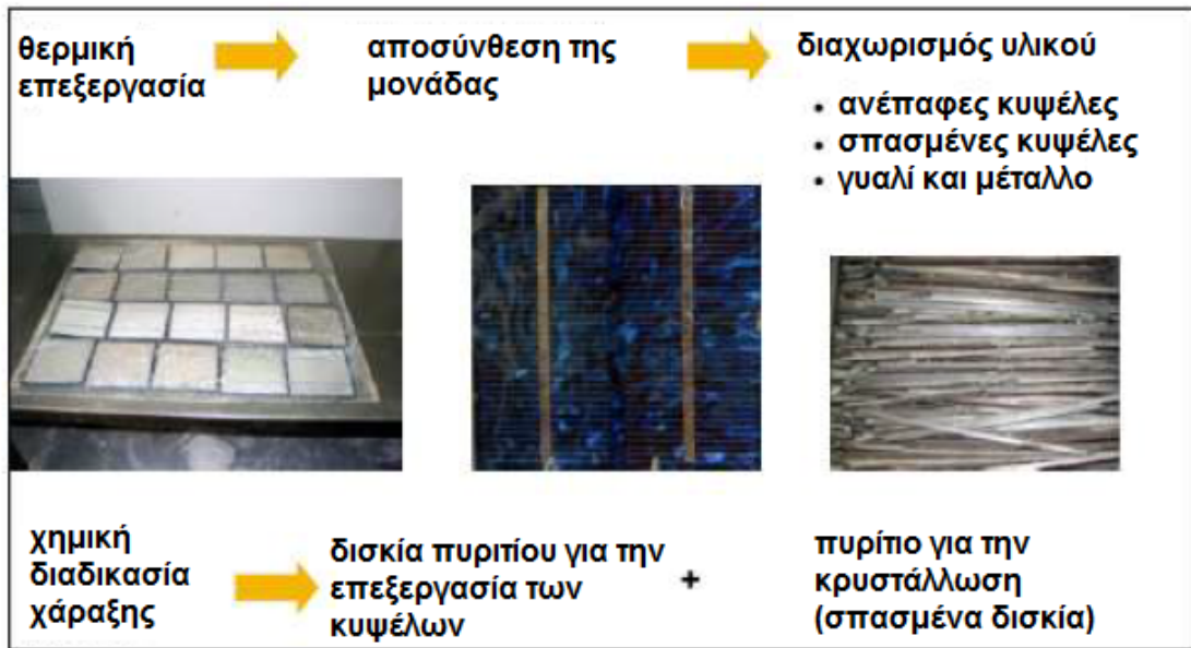
Σχήμα 20: αποσύνθεση μονάδας μέσω θερμικής επεξεργασίας της Deutsche Solar (πηγή: PVcycle)
