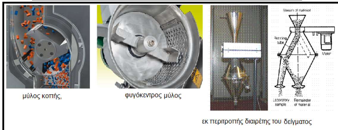
Σχήμα 42 : Μύλος κοπής, Φυγόκεντρος μύλος και εκ περιτροπής διαιρέτης του δείγματος
