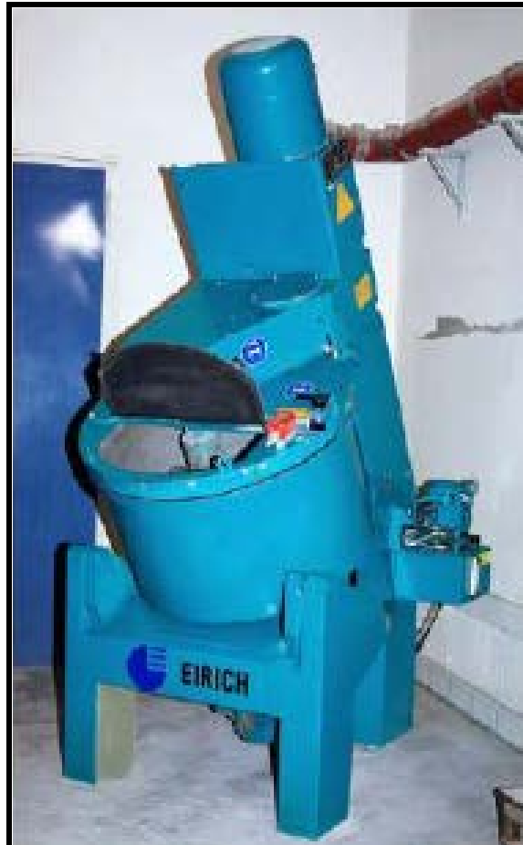
Σχήμα 29: Μίξερ που χρησιμοποιείται για τη διαδικασία τριβής( Eirich Intensive Mixer 150L )
