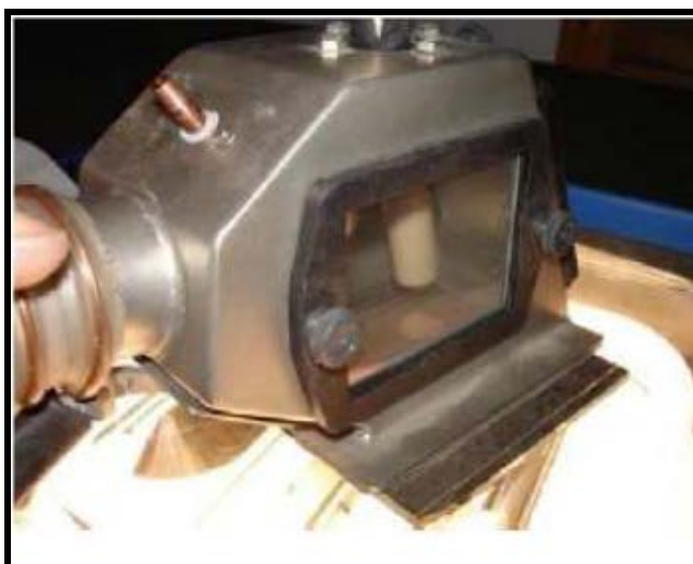
Σχήμα 28: Κάλυμμα αμμοβολής κενού (RESOLVED 2007)
