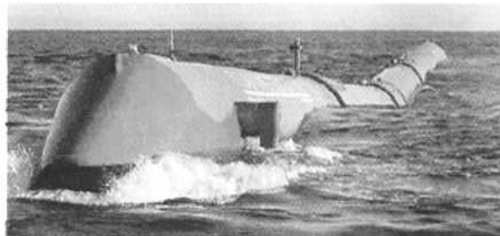
Εικόνα 3.3 : Το Pelamis σε λειτουργία. Το πρωτότυπο είναι τοποθετημένο στο European Marine Energy Center, στο Orkney της Σκωτίας
