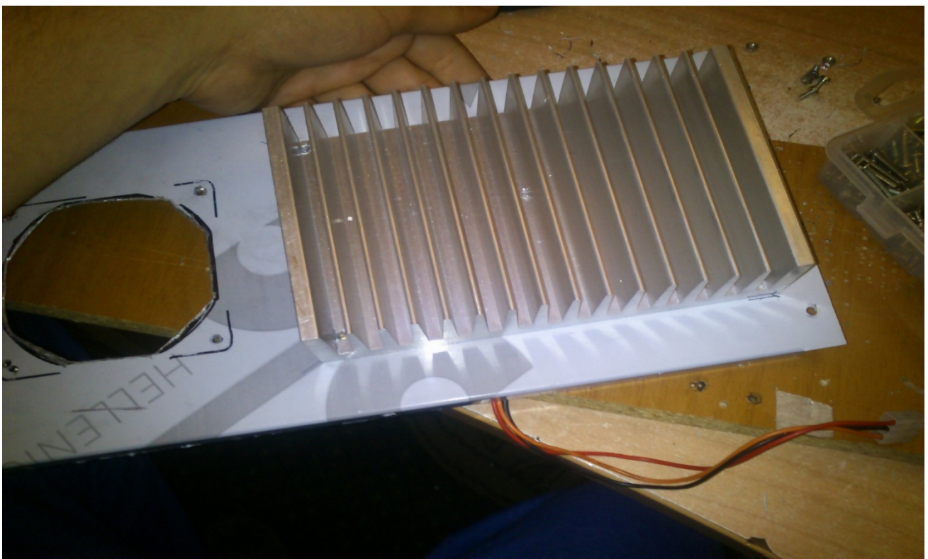
Εικόνα 6.6 : Τοποθέτηση της ψήκτρας στο σασί της κατασκευής
