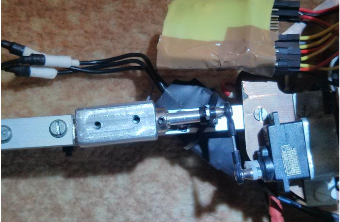
Εικόνα 3.20: Κάτοψη του μηχανισμού στρέψης του M1
