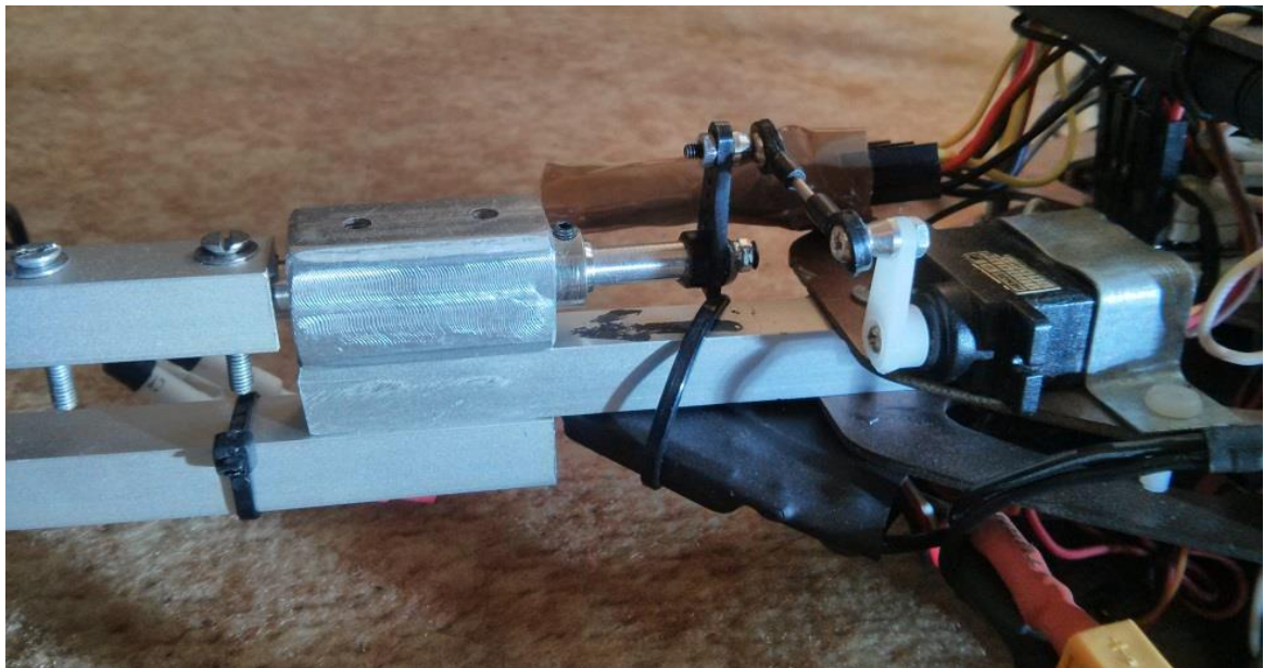
Εικόνα 3.19: Πλάγια όψη του μηχανισμού στρέψης του M1
