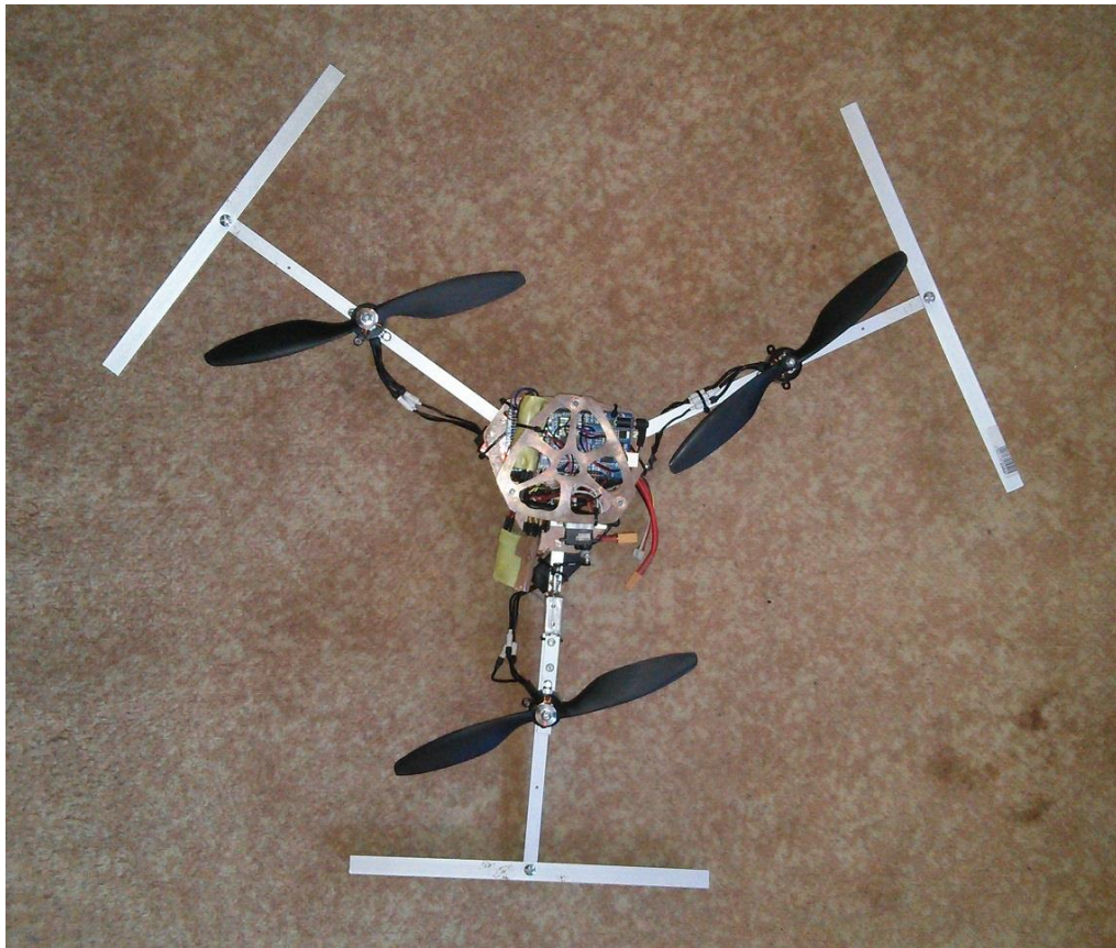
Εικόνα 3.18: Κάτοψη της τελικής μορφής του tricopter
