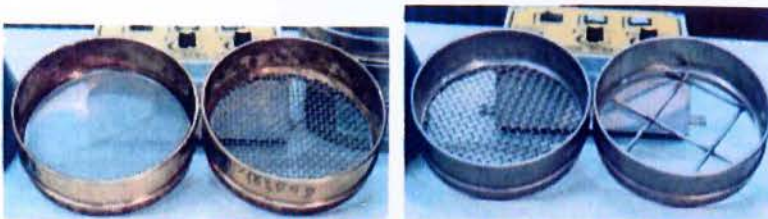
Σχήμα 2.2: Κόσκινα (από αριστερά) No200, No4, 6.3 mm, 75 mm (φωτ. Εργαστήριο Δομικής Μηχανικής)
