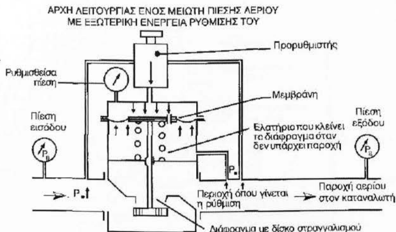
σχ. 2.29 Αρχή λειτουργίας ενός μειωτήρα πίεσης αερίου με εξωτερική ενέργεια ρύθμισης του
