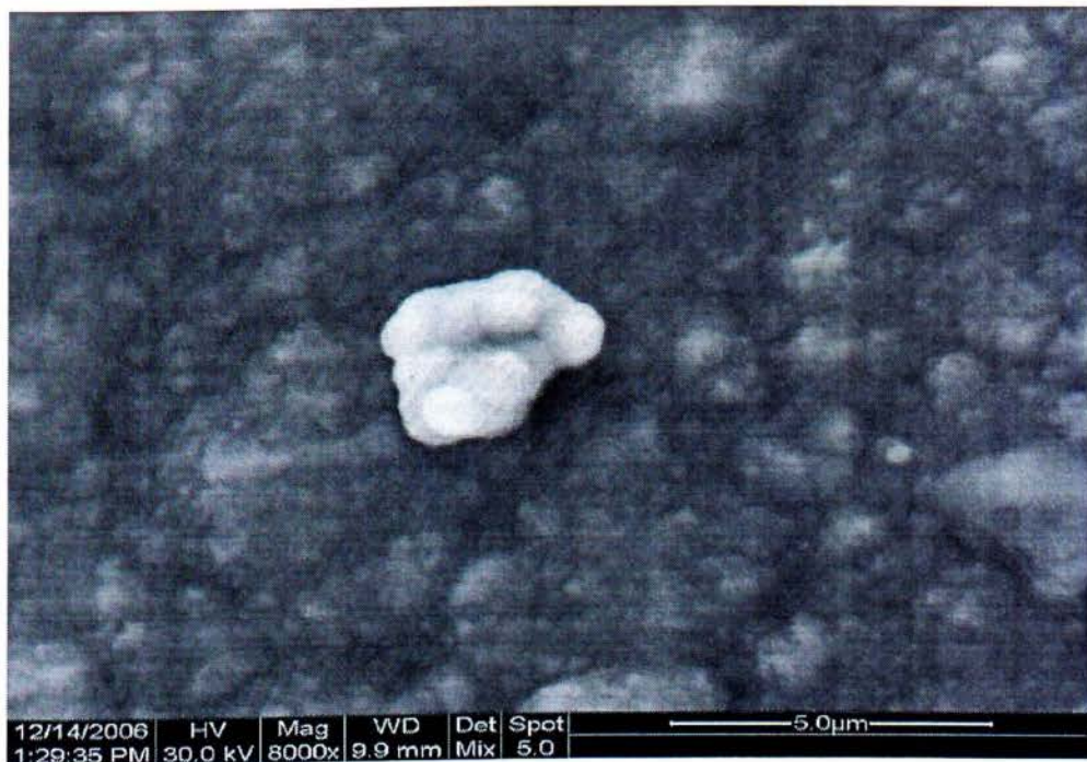
Μικρογραφία 3.4. Μορφολογία επιφάνειας σύνθετου αποθέματος Ni/SiC σε υπόστρωμα χάλυβα (d.c = 90%, \nu = 0,01 Hz) (8000.).
