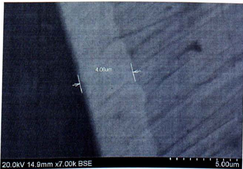
{Σχήμα 5.2.1}. SEM μικρό-γράφημα του διαγώνια τεμαχισμένου επιστρώματος του νιτρίδιου του τιτανίου TiN σε υπόστρωμα ανοξείδωτου χάλυβα πριν από την φόρτωση.
