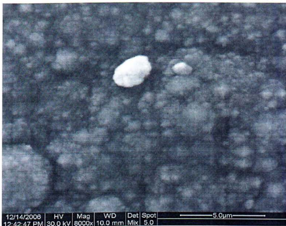
Μικρογραφία 3. Μορφολογία επιφάνειας συνθέτου αποθέματος Ni/SiC σε υπόστρωμα χάλυβα σε συνθήκες συνεχούς ρεύματος (8000.).
