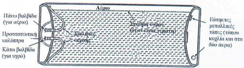
α. Κυλινδρική χαλύβδινη δεξαμενή υγροποιημένου χλωρίου (χωρητικότητα 1short ton=907 kg)
