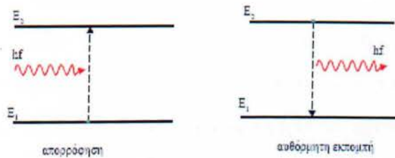
Σχήμα 6. Ενεργειακό διάγραμμα απορρόφησης και αυθόρμητης εκπομπής ακτινοβολίας από άτομο δύο ενεργειακών καταστάσεων.
