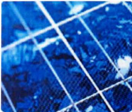
Σχήμα 2.5: Τυπικό φωτοβολταϊκό στοιχείο πολυκρυσταλλικού πυριτίου ([14])
