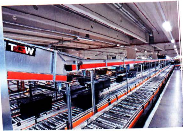
Σχήμα 4.4 Μεταφορική ταινία διαχείρισης για τα χαρτοκιβώτια και βαλίτσες σε ένα κέντρο διανομής.
