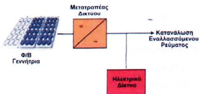
Σχήμα 3.43. Σχηματική παράσταση διασυνδεδεμένου Φ/Β συστήματος
