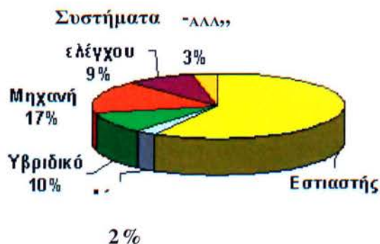
Σχήμα 3.53. Κατανομή κόστους των συστημάτων δίσκου/μηχανής
