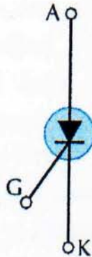
Σχήμα 17. Ισοδύναμη δομή ενός ελεγχόμενου ανορθωτή πυριτίου
