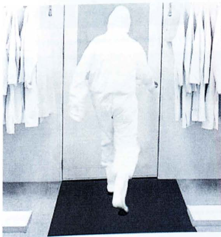
Εικόνα 3.8: Ειδικός τάπητας για την κατακράτηση σωματιδίων πριν την είσοδο στον καθαρό χώρο [12].
