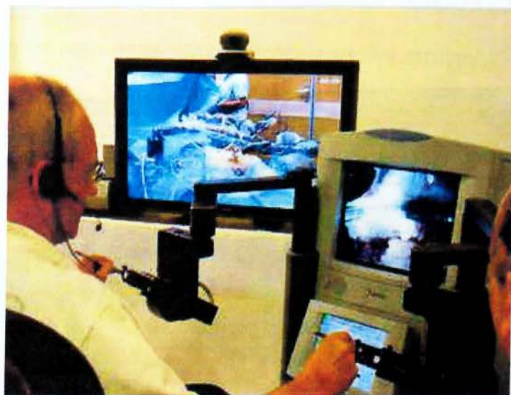
Εικόνα 37. da Vinci-Χειρουργική κονσόλα, ενδοσκοπικός πύργος και χειρουργικοί βραχίονες (A) - Zeus (B)
