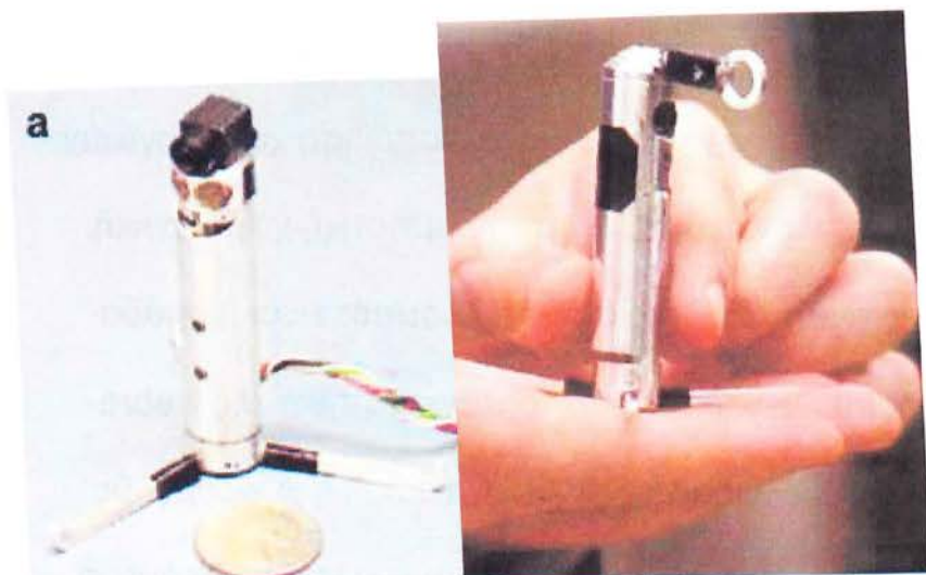
Εικόνα 42. Μικρο-ρομπότ εξοπλισμένο με μικροκάμερα και δυνατότητα κινήσής της σε δύο άξονες
