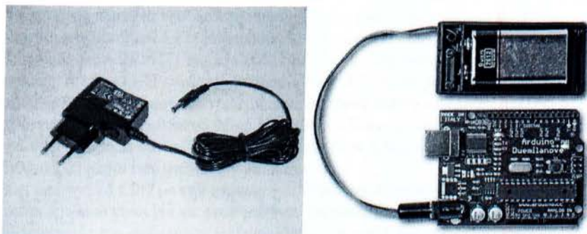
Εικόνα 2.1.4.1 και 2.1.4.2: Τροφοδοσία με DC προσαρμογέα ή με αλκαλική μπαταρία
