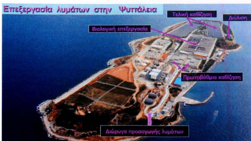
Εικόνα 3.1 -1: Επεξεργασία υγρών αποβλήτων στο ΚΕΛ Ψυττάλειας (Πηγή: Γ. Στεφανάκου, Σ. Λυκοσκούφης, Παραγωγή βιοαερίου και ενεργειακή αξιοποίησή του στο κέντρο επεξεργασίας λυμάτων Ψυττάλειας)
