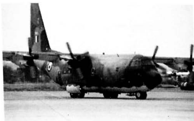
Εικόνα 2.1: C-130H, τετρακινητήριο μεταγωγικό, μήκους 29,8m, ύψους 11,6m και βάρους 38tn (άδειο). Η μεταφορική του ικανότητα είναι 20tn, η μέγιστη ταχύτητα του 621 km/h και με πλήρωμα 5 άτομα.
