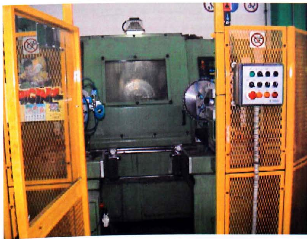
Εικόνα 4: Τόρνος με εξωτερικές πόρτες με σύστημα Ενδομανδάλωσης .
