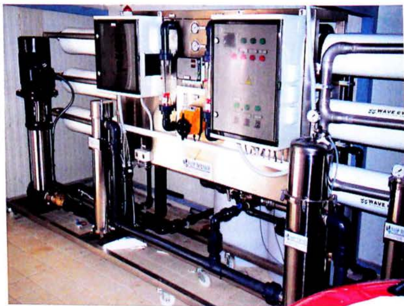
ΕΙΚΟΝΑ 5.15: Μονάδα επεξεργασίας υφάλμυρου νερού, με τη μέθοδο της αντίστροφης ώσμωσης, για βιομηχανική χρήση της Ελληνικής εταιρείας hydortech με δυνατότητα παραγωγής 11200 με 16000 λίτρα ανά ώρα.
