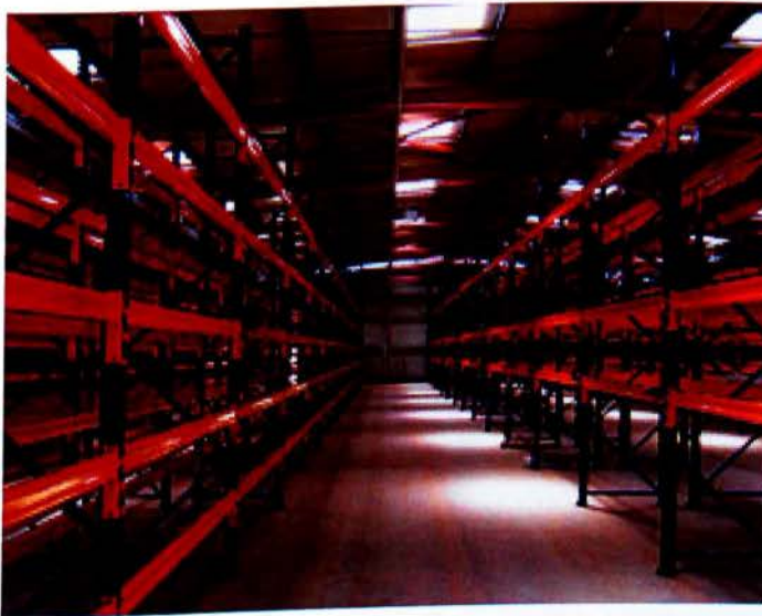
Εικόνα 5.3: Συστήματα προβολικών ραφιών για την αποθήκευση φορτίων μεγάλου μήκους.
