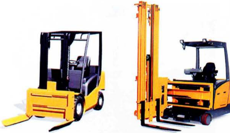
ΕΙΚΟΝΑ 5.6: Από αριστερά α) Περονοφόρο ανυψωτικό με αντίβαρο, β) Περονοφόρο ανυψωτικό στενών διαδρόμων.
