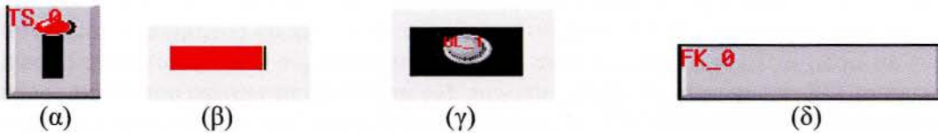
Σχήμα 5.8: (α) Το γραφικό του toggle switch (β)(γ) Το γραφικό του bit lamp (δ) Το γραφικό του function key
