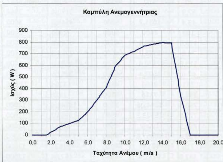
Σχ.5.8.2. Καμπύλη Ισχύος Ανεμογεννήτριας
