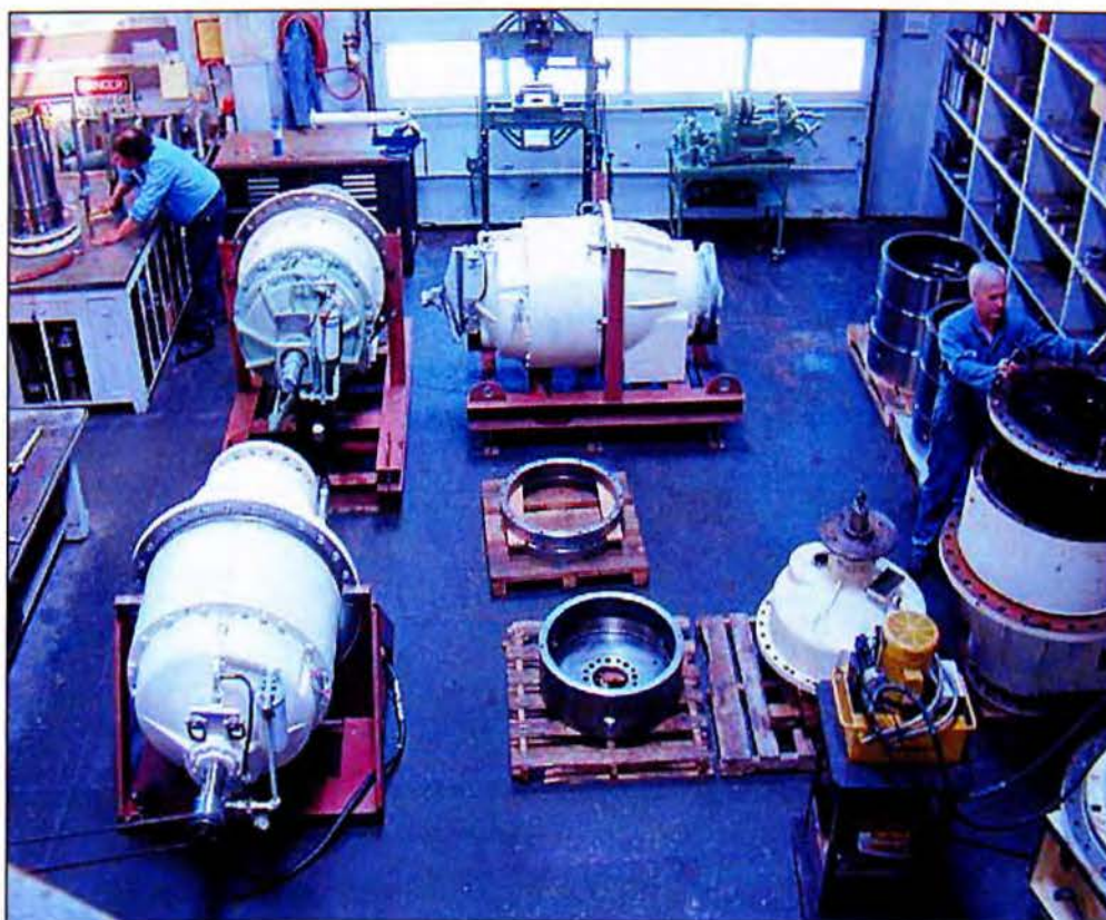
Σχήμα 1.5.3 Κιβώτιο ταχυτήτων ανεμογεννήτριας κατά την κατασκευή του.
