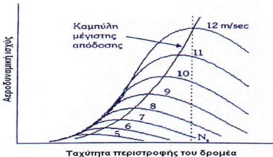
Σχήμα 1.4.4: Καμπύλες αεροδυναμικής ισχύος – στροφών του δρομέα, με παράμετρο την ταχύτητα του ανέμου και βέλτιστη καμπύλη λειτουργίας.
