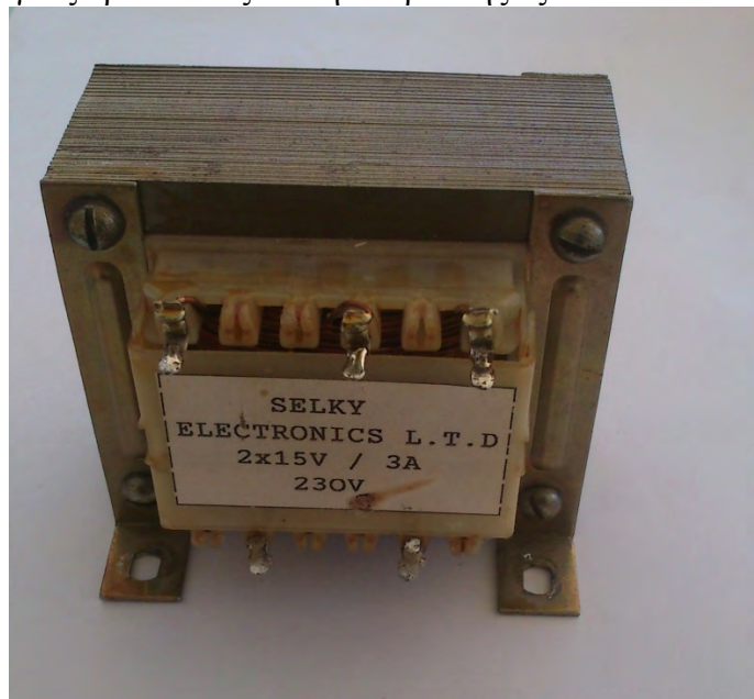
Σχήμα 6.16: Φωτογραφία μετασηματιστή τάσης από το κατασκευαστικό μέρος της εργασίας.
