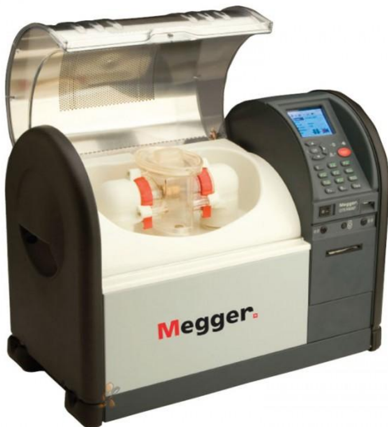
Εικόνα 4.35 Συσκευή ελέγχου διηλεκτρικής αντοχής του μονωτικού λαδιού
