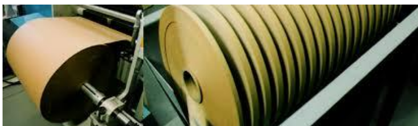
Εικόνα 3.29 Παρασκευή χαρτιού Insuldur
