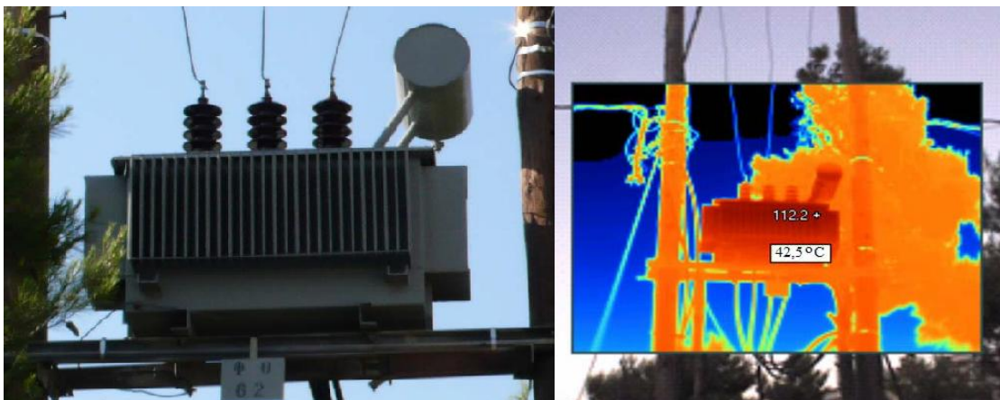
Εικόνα 4.38 φωτογραφία μετασχηματιστή από θερμογραφική κάμερα
