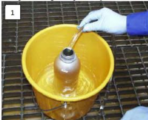
Εικόνα 4.32 Δειγματοληψία μονωτικού λαδιού
