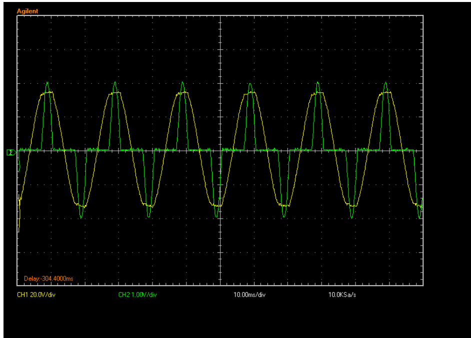
Γράφημα 6.11.α: Κυματομορφές χωρίς PFC, U_{IN}= 26V (κίτρινο), I_{IN}= 4A (πράσινο)
