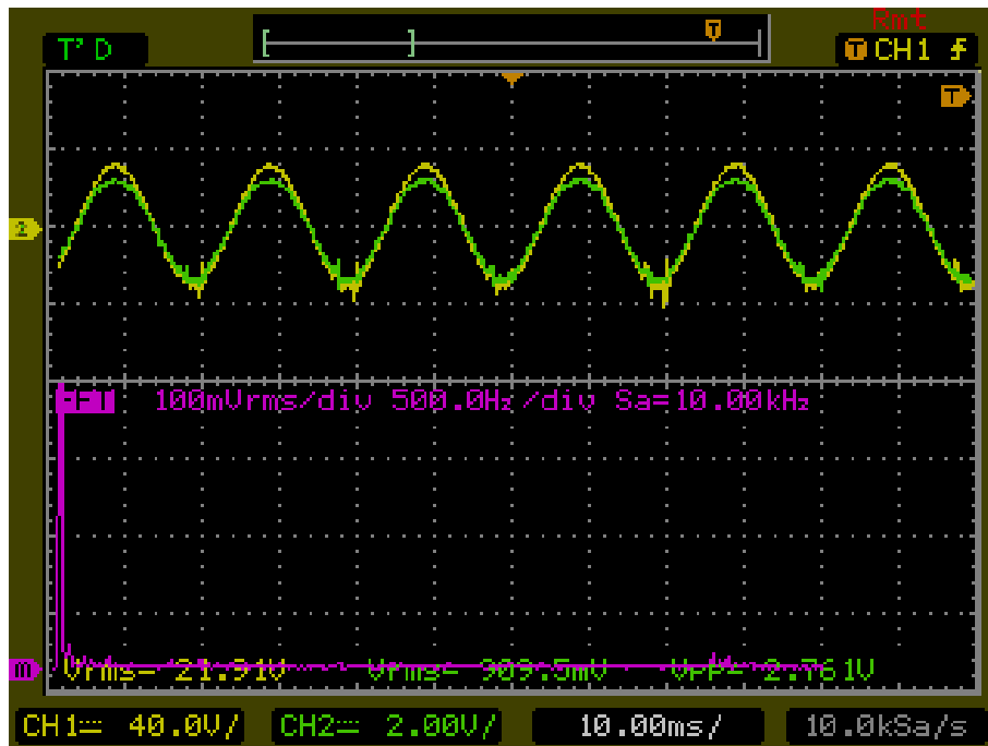
Γράφημα 6.4.β: Κυματομορφές με PFC, U_{IN}= 22V (κίτρινο), I_{IN}= 4A (πράσινο) και ανάλυση Fourier I_{IN} (μωβ)
