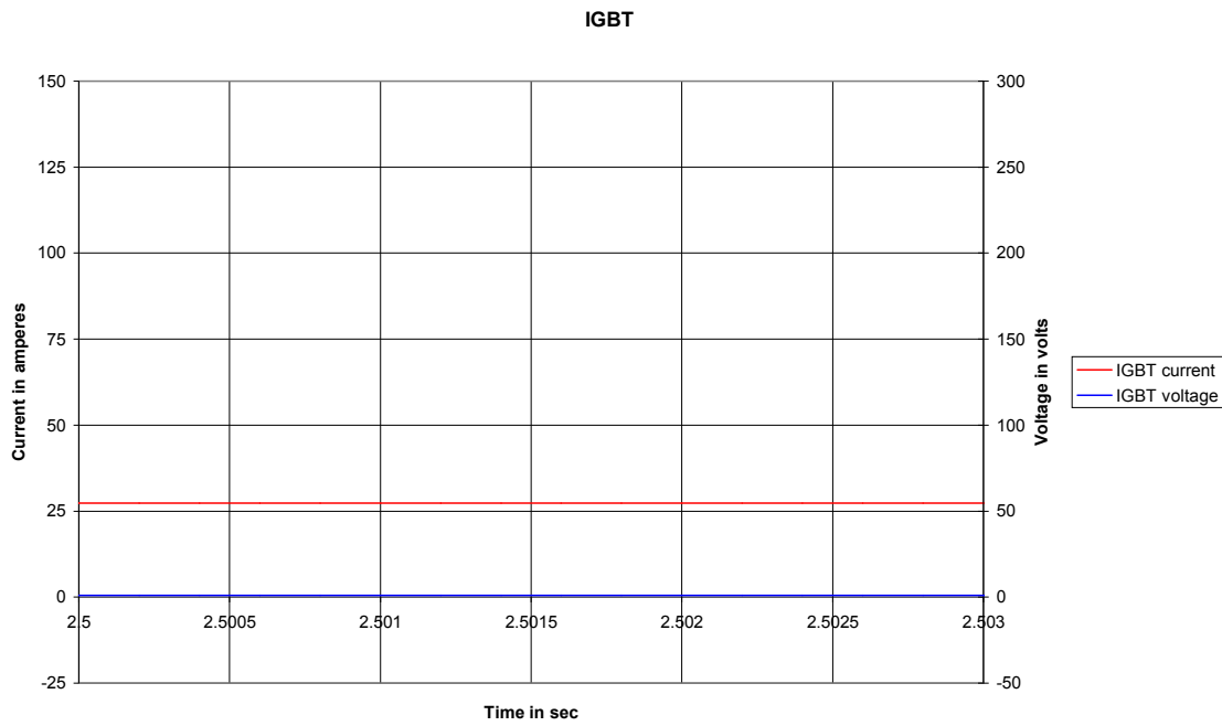
Σχήμα 4.155 Κυματομορφές τάσης και ρεύματος στα άκρα του IGBT M1, d=100\% , load 100%
