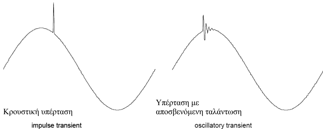
Σχήμα 3.18 Μεταγωγικές υπερτάσεις παλμικού και κλιμακούμενου τύπου
