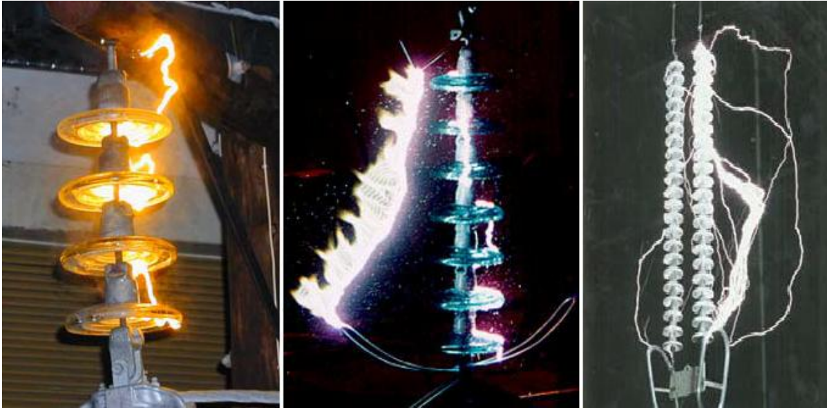
Σχήμα 2.9 Υπερπήδηση αλυσοειδούς μονωτήρα.
