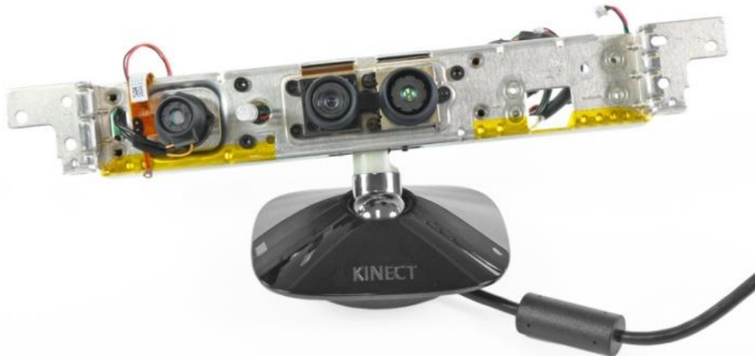
Εικόνα 2.3: Από δεξιά στα αριστερά: Υπέρυθρη κάμερα, RGB κάμερα, LED και υπέρυθρος προβολέας.
