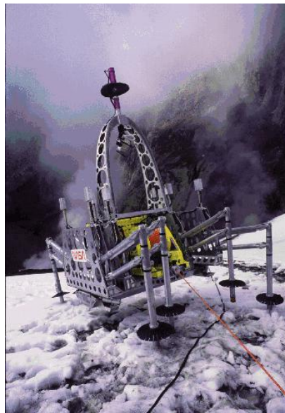
Εικόνα 13: Ο Dante II του Εργαστηρίου JPL της NASA κατά τη διάρκεια ανάβασης σε βουνό της Αλάσκα
