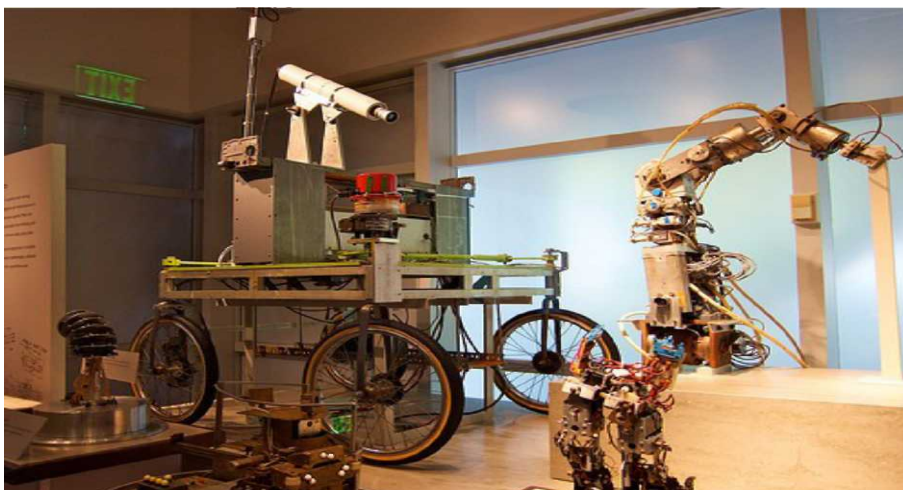
Εικόνα 38: Το εξοπλισμένο Stanford Cart με στερεοσκοπική όραση
