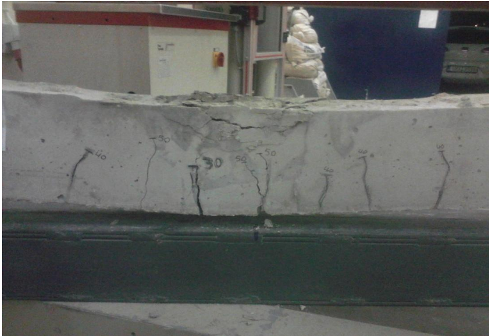
ΕΙΚΟΝΑ 4.9:ΚΑΜΠΤΙΚΗ ΑΣΤΟΧΙΑ ΔΟΚΟΥ BV-2 FLEX 2
