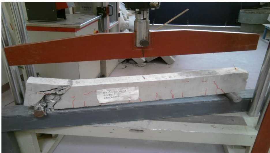
ΕΙΚΟΝΑ 3.9:ΔΟΚΟΣ BV-3 ΜΕΤΑ ΤΗ ΦΟΡΤΙΣΗ 1
