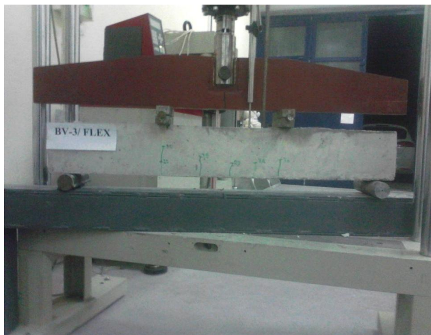
ΕΙΚΟΝΑ 4.12:ΕΠΕΚΤΑΣΗ ΡΗΓΜΑΤΩΣΕΩΝ
