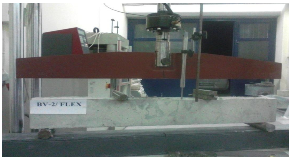
ΕΙΚΟΝΑ 4.3: BV-2 FLEX ΠΡΙΝ ΤΗ ΦΟΡΤΙΣΗ
