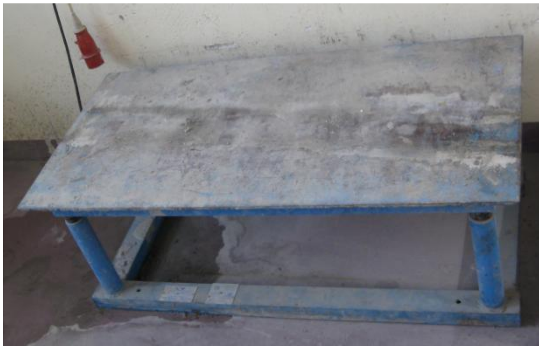
ΕΙΚΟΝΑ 3.5: ΤΡΑΠΕΖΑ ΔΟΝΗΣΗΣ ΣΚΥΡΟΔΕΜΑΤΟΣ
