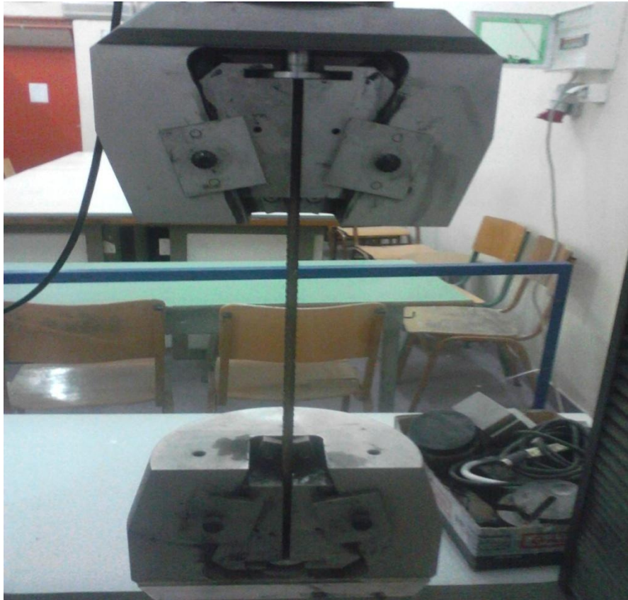
ΕΙΚΟΝΑ 4.18:ΕΜΦΑΝΙΣΗ ΛΑΙΜΟΥ ΣΤΟ ΔΟΚΙΜΙΟ
