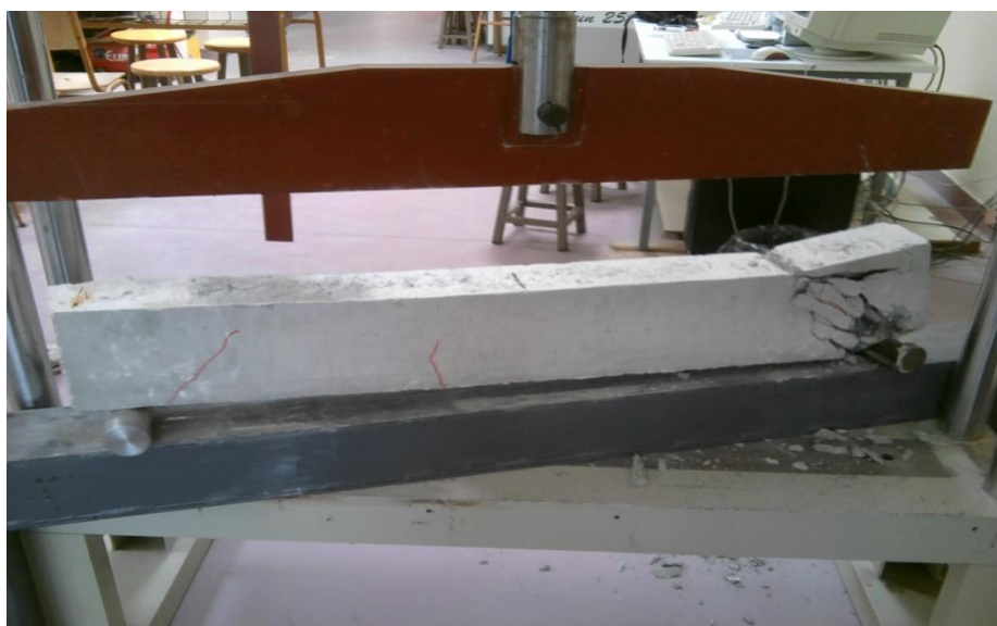
ΕΙΚΟΝΑ 3.10:ΔΟΚΟΣ BV-3 ΜΕΤΑ ΤΗ ΦΟΡΤΙΣΗ 2
