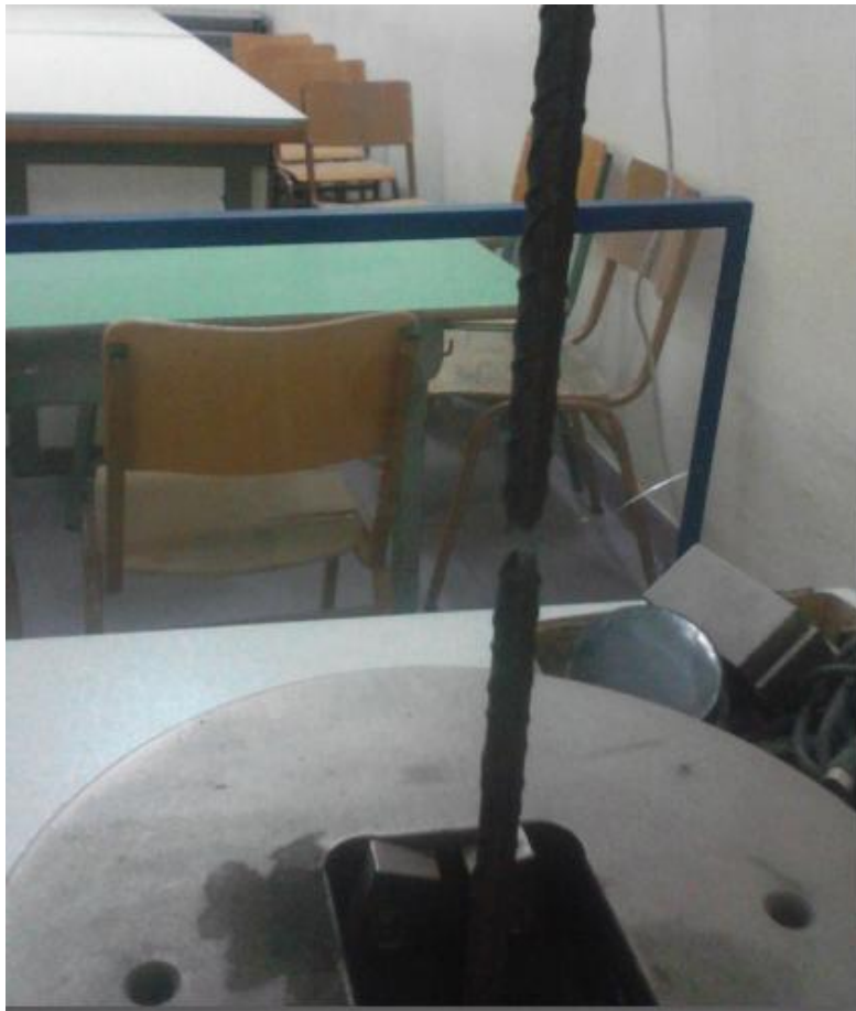
ΕΙΚΟΝΑ 4.19:ΘΡΑΥΞΗ ΤΟΥ ΧΑΛΥΒΑ
