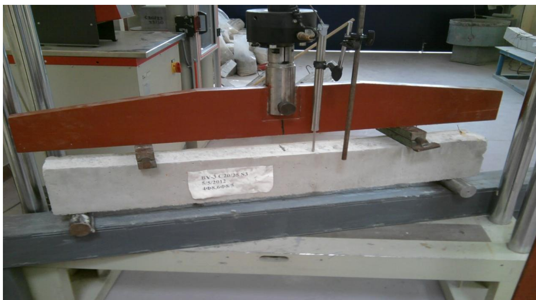
ΕΙΚΟΝΑ 3.8:ΔΟΚΟΣ BV-3 ΠΡΙΝ ΤΗ ΦΟΡΤΙΣΗ
