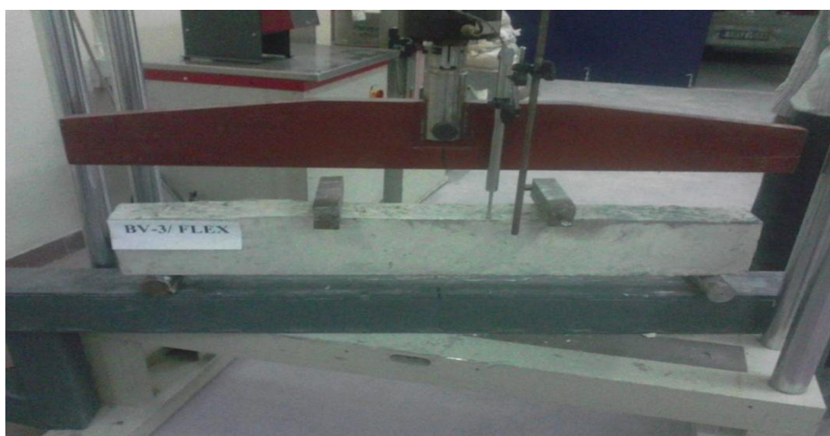
ΕΙΚΟΝΑ 4.4: BV-3 FLEX ΠΡΙΝ ΤΗ ΦΟΡΤΙΣΗ
