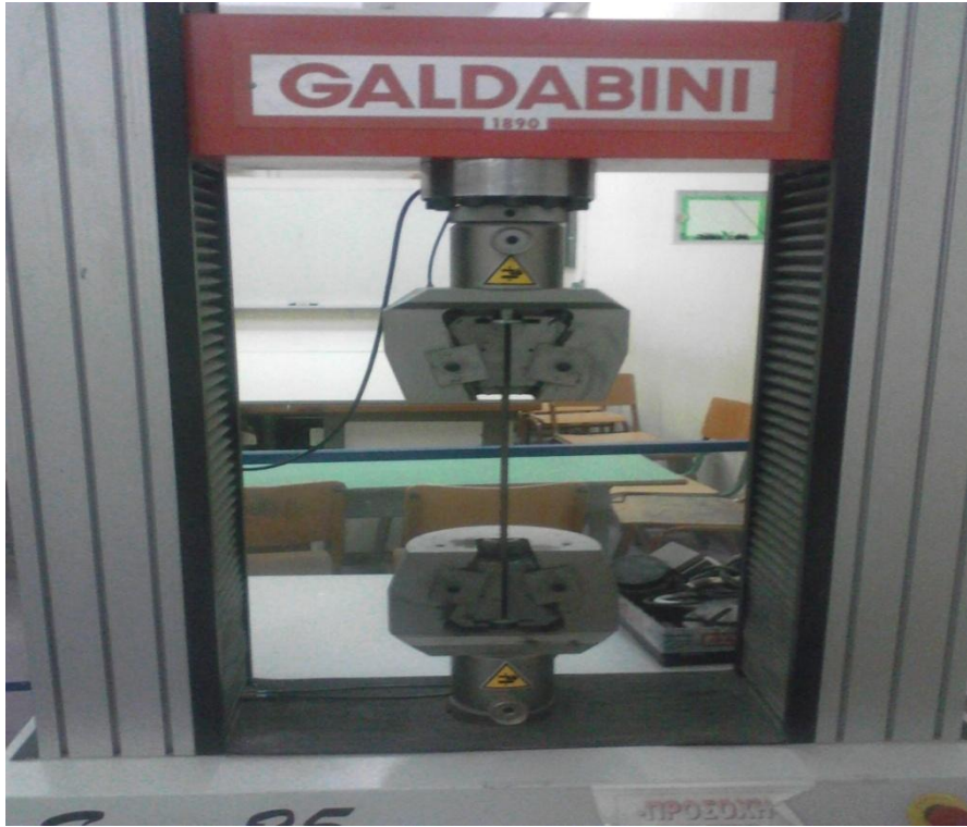
ΕΙΚΟΝΑ 4.17:ΕΝΑΡΞΗ ΔΟΚΙΜΗΣ ΕΦΕΛΚΥΣΜΟΥ ΔΟΜΙΚΟΥ ΧΑΛΥΒΑ
