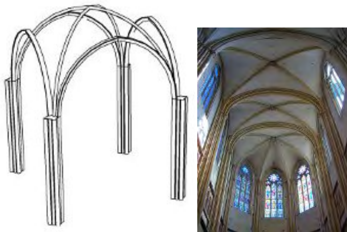
Εικόνα 3.20: Διάγραμμα πλευρικού θόλου και εφαρμογή του στον Καθεδρικό Ναό του Αγίου Μπενίνζ στην Ντιζόν της Γαλλίας
