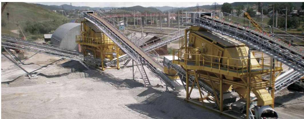
Εικόνα 72: Πλήρης ανάπτυξη σταθερής μονάδας στο χώρο εργασίας, με εμφανείς τους ταινιόδρομους που επικοινωνούν τα διάφορα τμήματα της μονάδας. (Πηγή: http://www.imas-conveyors.com/index_el.html )
