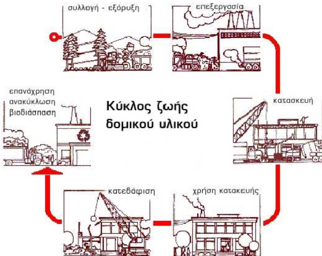
Εικόνα 4: Ο κύκλος ζωής ενός δομικού υλικού. (Πηγή: Α. Γ. Κορωναίος, Γ. Φ. Σαργέντης, 2005)
