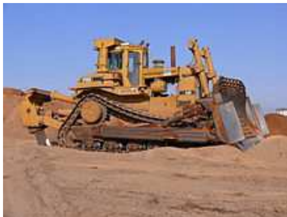
Εικόνα 53: Μπουλντόζα μάρκας Caterpillar μοντέλο D10N με σπαστήρα μονού μαχαίριού.
