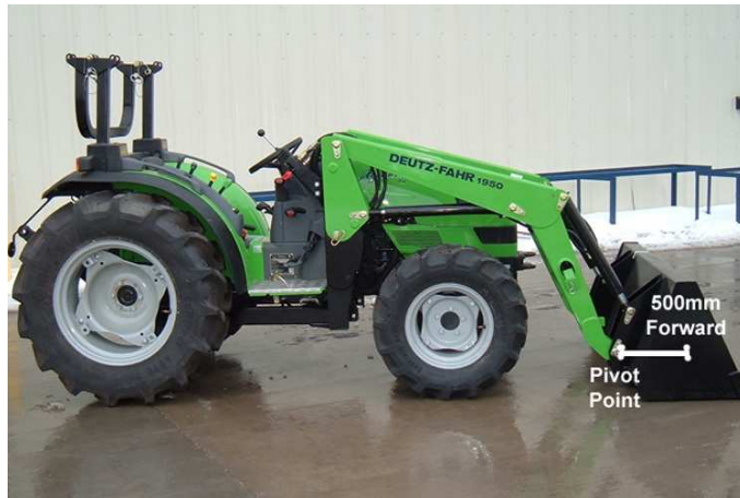
Εικόνα 40: Συμπαγούς μεγέθους τρακτέρ με ενσωματωμένη μπροστινή κουτάλα, όπου φαίνονται τα δυο διαφορετικά σημεία μέτρησης για την χωρητικότητα του κουβά φόρτωσης.
