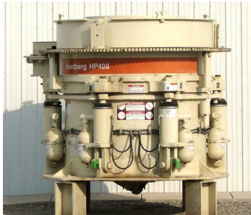
Εικόνα 67: Θραυστήρας κώνου Nordberg HP400 Cone Crusher (Πηγή: http://en.wikipedia.org/wiki/Jaw_crusher#Jaw_crusher )
