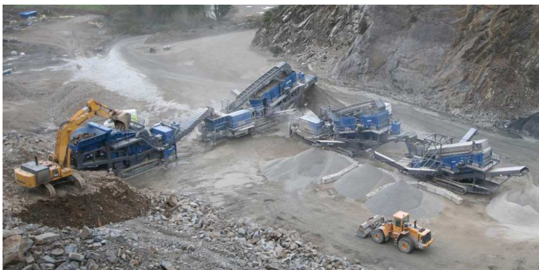
Εικόνα 68: Συνδυασμός φορητών θραυστήρων που μπορούν να λειτουργήσουν σαν μια πλήρως λειτουργική μονάδα επεξεργασίας και διαβάθμισης (Πηγή: http://www.kleemann.info/de )
