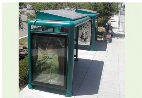
Εικόνα 22. Στάση λεωφορείου με ενσωματωμένα φωτοβολταϊκά στην οροφή.
