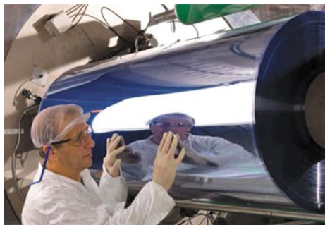
Εικόνα 41. Μία από τις προσδοκίες της βιομηχανίας χάλυβα στην Ευρώπη, είναι να χρησιμοποιήσει OPV ενότητες φωτοβολταϊκών που παράγονται ως ένα πλαστικό film σε ρολό.
