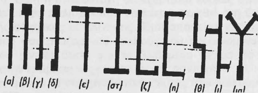
Σχ. 5.5 Συνηθισμένες διατομές φερόντων φερόντων τοιχωμάτων
