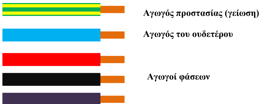
Σχήμα 1.2 Διακριτικά χρώματα μονώσεων
