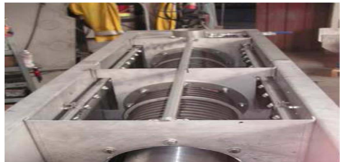
Εικόνα 3.4 Κοχλιωτή διάταξη πάχυνσης αφυδάτωσης
