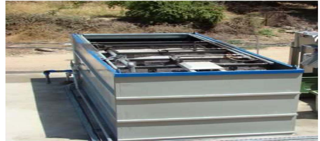
Εικόνα 3.3 Εγκατεστημένο συγκρότημα βιολογικής επεξεργασίας M.B.B.R.
