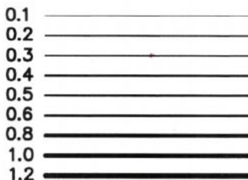
Εικόνα 6: Ραπιντογράφος και τα συνηθέστερα πάχη γραμμών του
