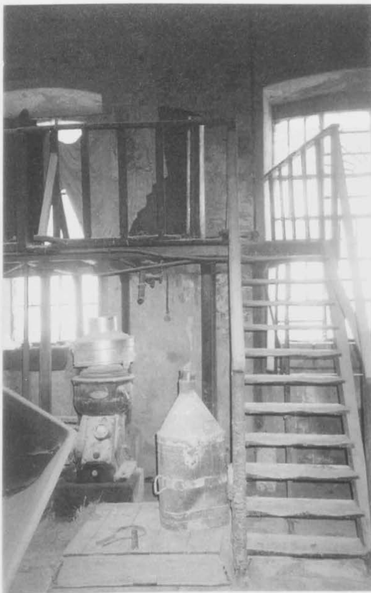
30 Ελαιοτριβείο Μητρέλια. Ελαιοδιαχωριστήρας (λαβάλ) από όπου έτρεχε το λάδι σε γανωμένα λαγήνια. Αριστερά της φωτογραφίας διακρίνεται η χαμουριέρα.
