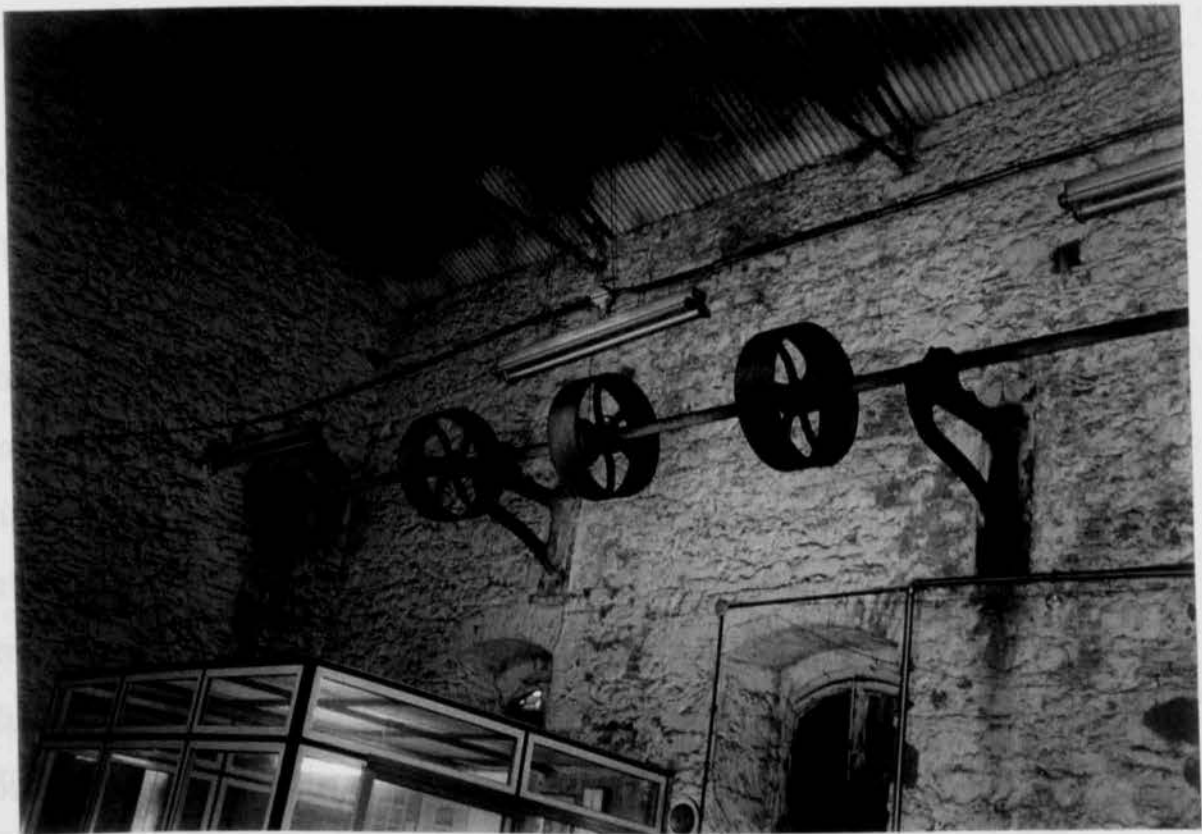
17,18 Ο άξονας με τις τροχαλίες στο ελαιοτριβείο Κοκκινοφόρου.
