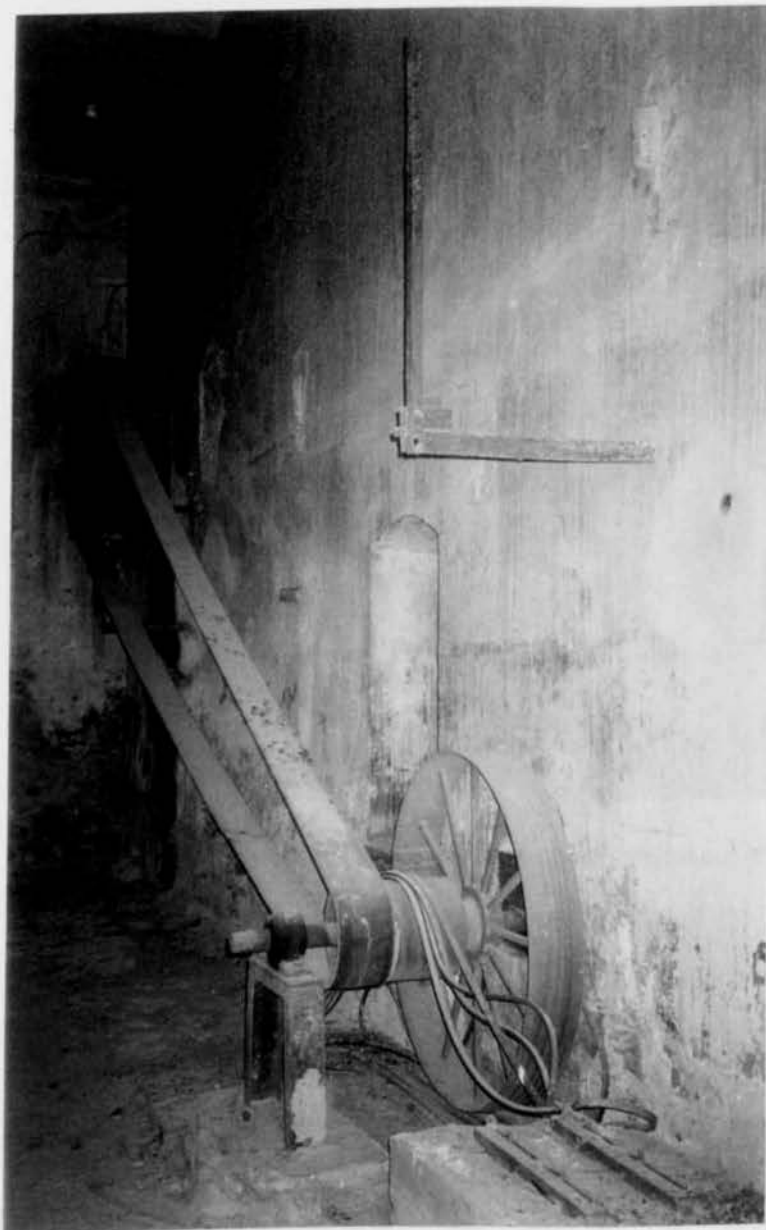
26. Ο μάντας κίνησης των μηχανημάτων. Ελαιοτριβείο Μητρέλια.
