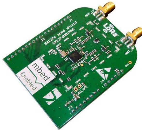
Εικόνα 37: Το module SX1276 τεχνολογίας LoRa της εταιρείας Semtech [44]
