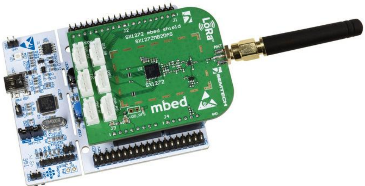
Εικόνα 26: Το LoRa module που χρησιμοποιήθηκε (Nucleo pack, P-NUCLEO-LRWAN1)
