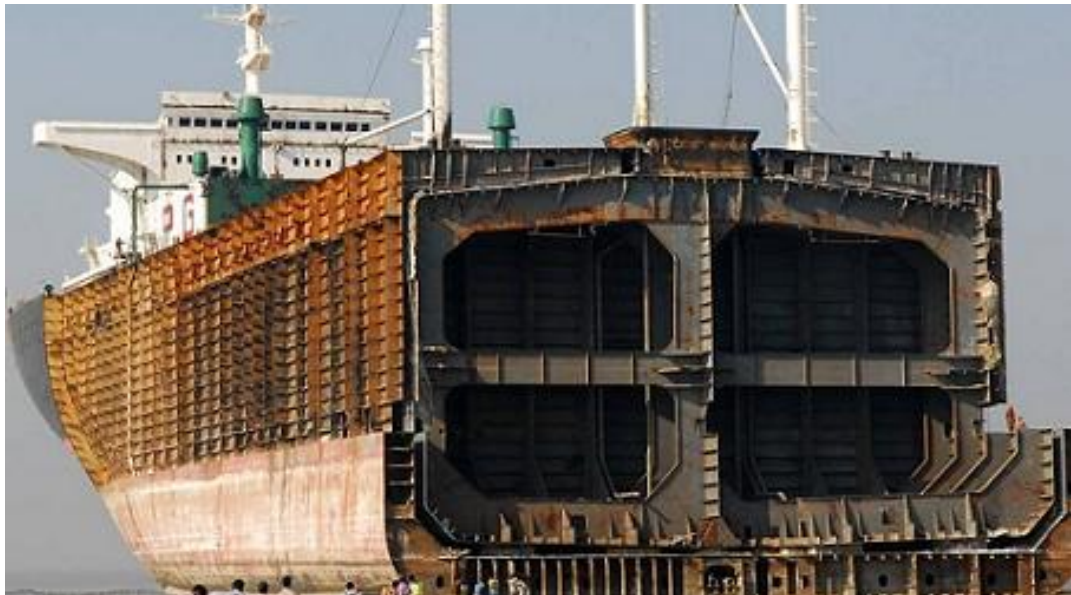
Εικόνα 9: Η μεταλλική δομή του πλοίου, [42].
