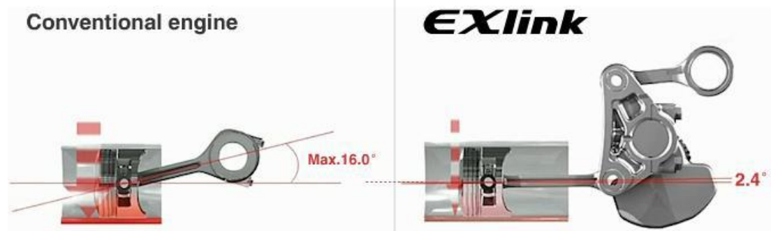
Εικόνα 9: Γωνία ταλάντωσης διωστήρα EXlink και συμβατικού συστήματος
