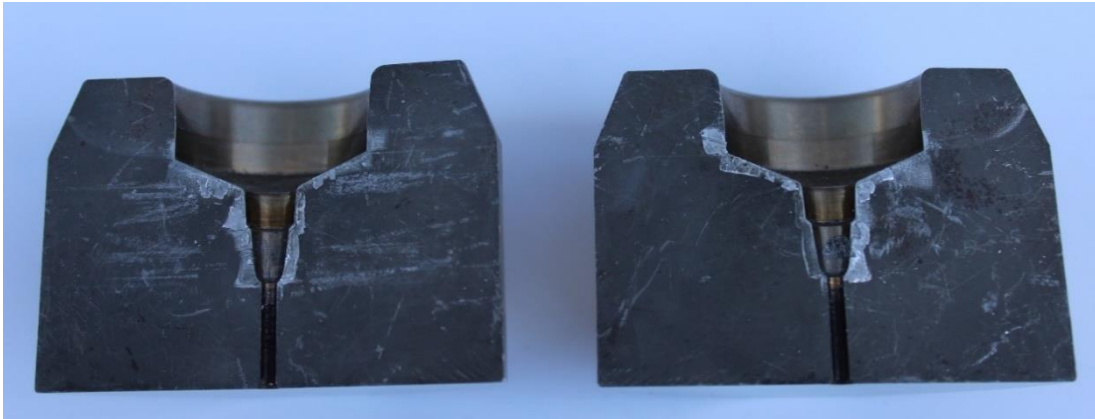
Εικόνα 5.10 Ποσότητα αλουμινίου που έχει συσσωρευτεί εντός της μήτρας
