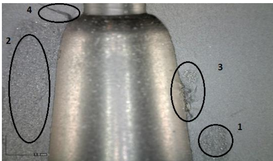
Εικόνα 7.10 Απεικόνιση περιοχών εκτενούς φθοράς στην επιφάνεια διαμόρφωσης ακροφυσίου
