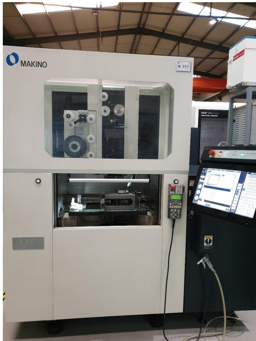
Εικόνα 7.1 Χρήσης μηχανής κοπής με ηλεκτροδιάβρωση για τον τεμαχισμό της μήτρας
