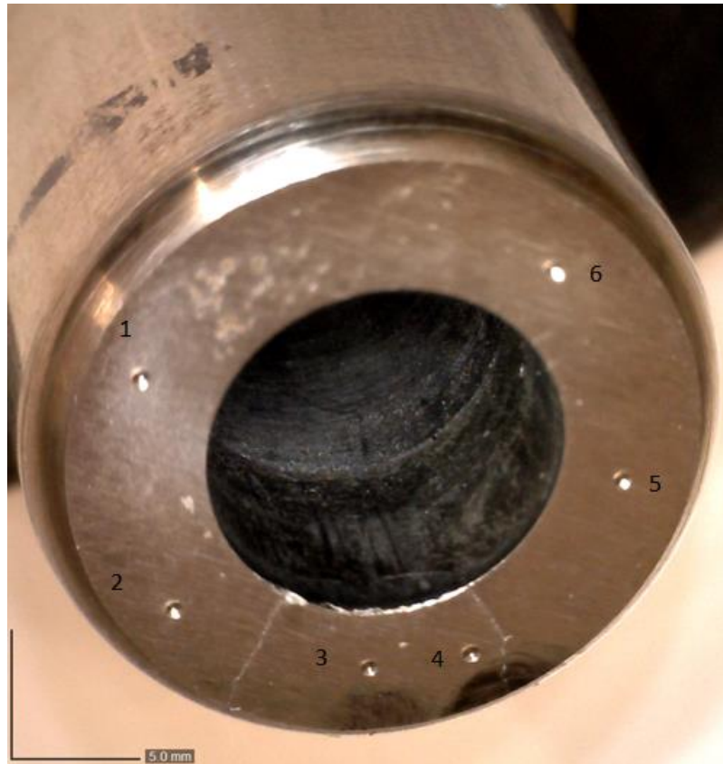
Εικόνα 6.4 Αποτύπωση μετρήσεων σκληρότητας στην εξωτερική του χιτωνίου.
