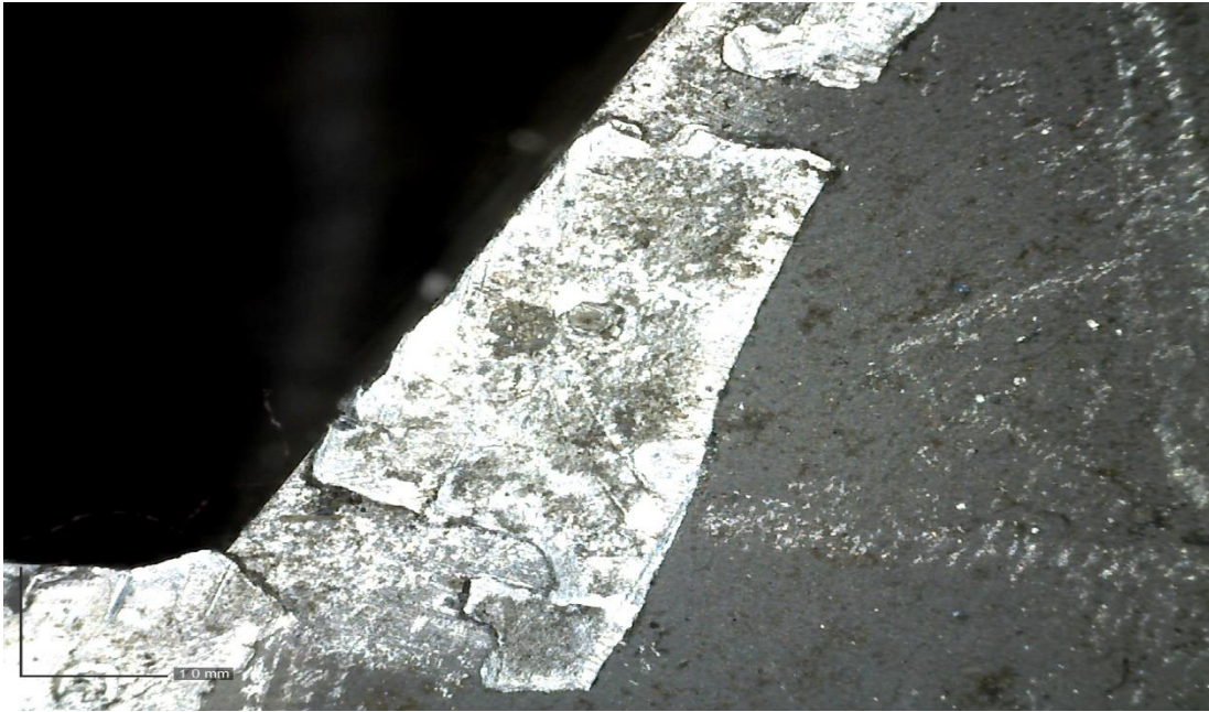
Εικόνα 7.9 Απεικόνιση ποσότητας αλουμινίου στην κωνική επιφάνεια της μήτρας
