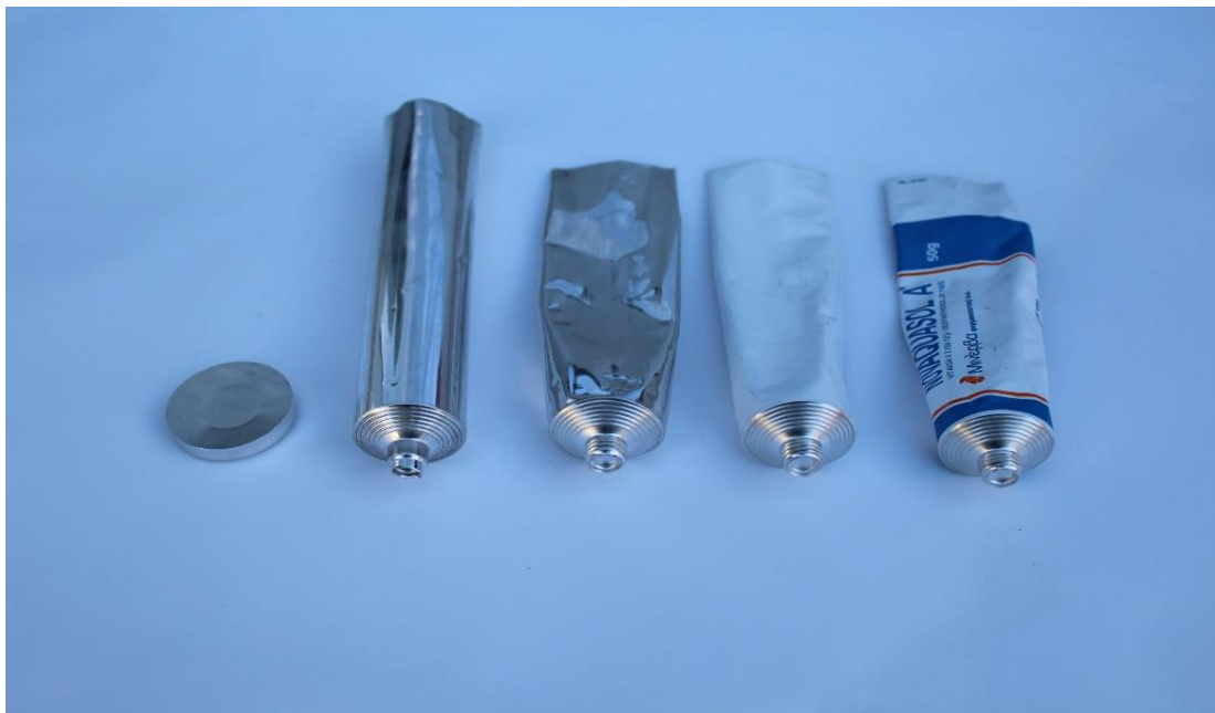
Εικόνα 4.1 Στάδια μορφοποίησης του σωληνάριου από αλουμίνιο με συνδυασμό βαθιάς κοίλανσης και τραβήγματος
