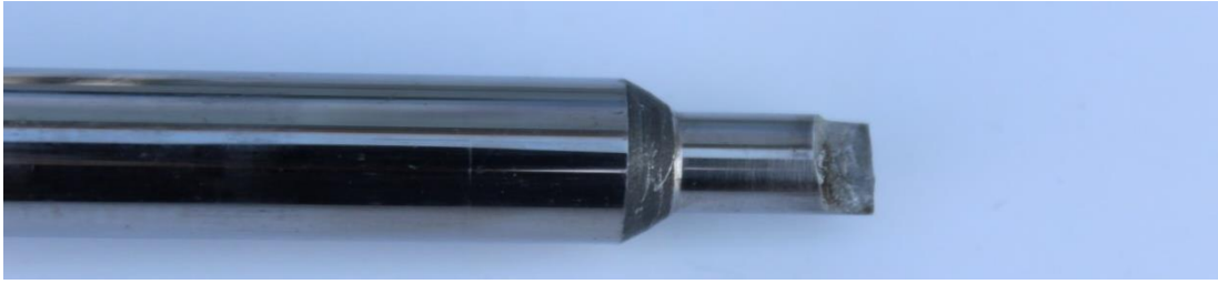
Εικόνα 5.13 Μερική θραύση στο βλήτρο
