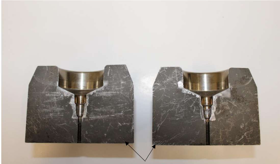
Εικόνα 5.6 Εσωτερική όψη της μήτρας όπου περιλαμβάνονται οι επιφάνειες θραύσης
