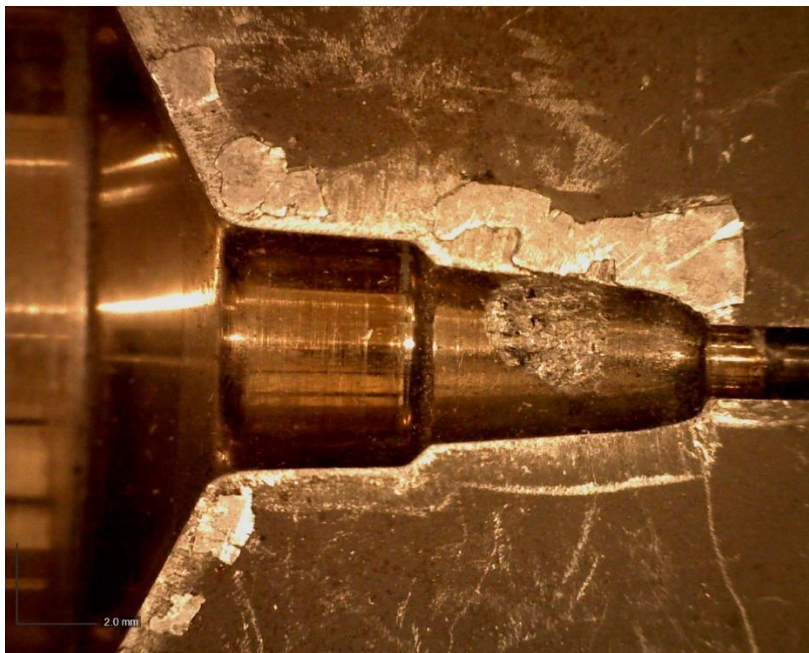
Εικόνα 5.9 Ποσότητα αλουμινίου στην εσωτερική επιφάνεια όπου πραγματοποιείται η διαμόρφωση του λαιμού
