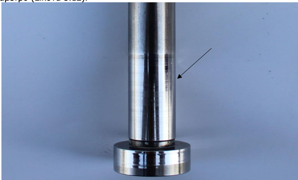
Εικόνα 5.12 Ανομοιόμορφες γραμμές φθοράς στο βλήτρο
