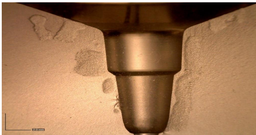
Εικόνα 5.7 Ποσότητα αλουμινίου στο εσωτερικό τμήμα της μήτρας
