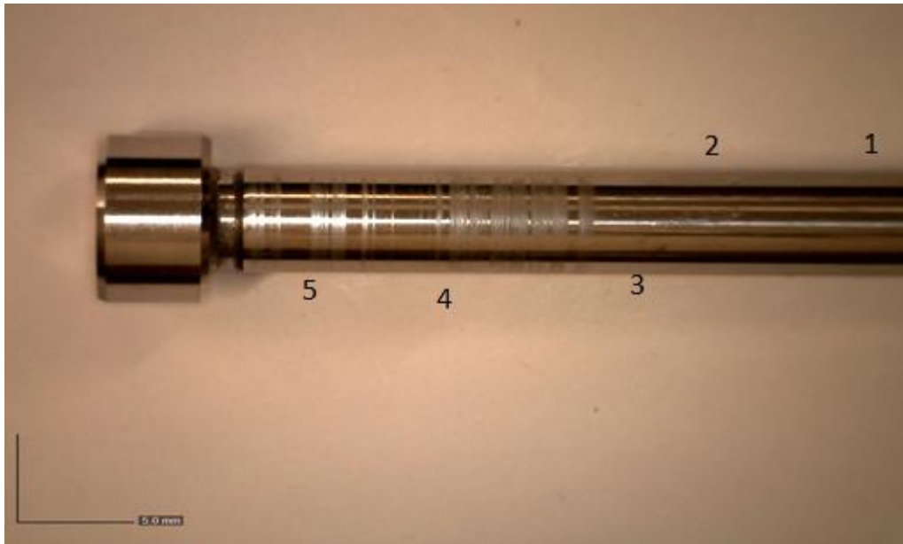
Εικόνα 6.3 Αποτύπωση μετρήσεων σκληρότητας στην εξωτερική του βλήτρου.
