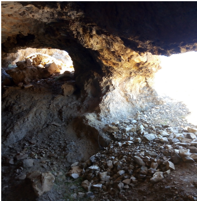
Εικ.238) δημιουργία ενός υποστυλώματος, η λεγόμενη "ποδαριά" όπου σήκωνε την οροφή προς αποφυγή μιας πιθανής πτώσης
