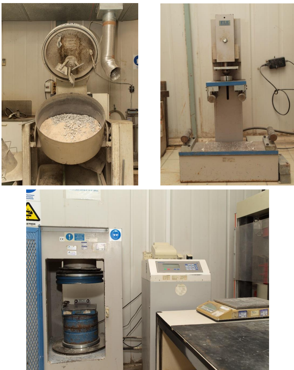
Φωτογραφία 1.3: Εργαστηριακές διατάξεις που χρησιμοποιήθηκαν για την παρασκευή και τον έλεγχο θλιπτικών και καμπτικών αντοχών των συνθέσεων ΚΣ.
