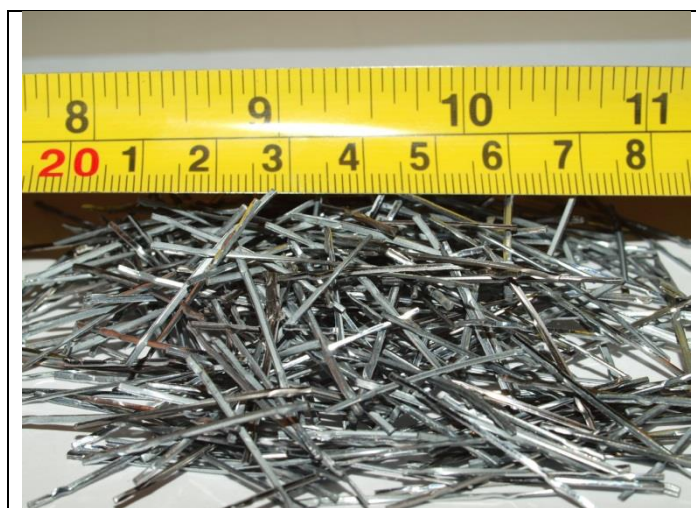
Φωτογραφία 1.1: Είδος των μεταλλικών ινών που χρησιμοποιήθηκαν
