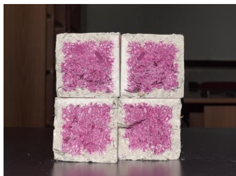
Φωτογραφία 2.1: Όψεις των δοκιμών μετά την θραύση τους και των ψεκασμό τους με διάλυμα φαινολοφθαλεΐνης
