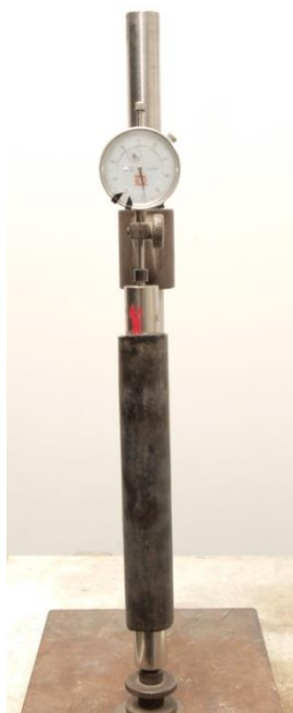
Φωτογραφία 2.7: Συσκευή μέτρησης του μήκους των δοκιμίων
