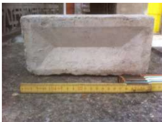
Εικόνα 3.5 Συμπαγής οπτόπλινθος σκαφοειδούς διατομής διαστάσεων 25 x 11,5 x 6,5 cm.
