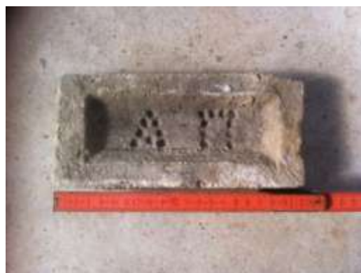
Εικόνα 3.6 Συμπαγής οπτόπλινθος σκαφοειδούς διατομής διαστάσεων 21,5 x 11,5 x 6,5 cm.
